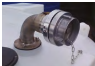
DC 7000 obere Füllung und Saugung C
